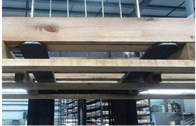
FIG. 5 – CAJA DE LAMINAM – RIELES CRUZADOS vista de una caja con horquillas de 84" debajo de los rieles
